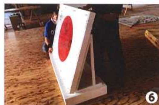
⑥フックがしっかりセットされ、転倒しないことを確認してください。なお、作業は必ず2名以上で行ってください。
