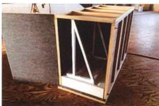
[ディスプレイ台座] 梱装箱内側には衝撃緩衝のためのパンチカーペットが仕込んであります。
